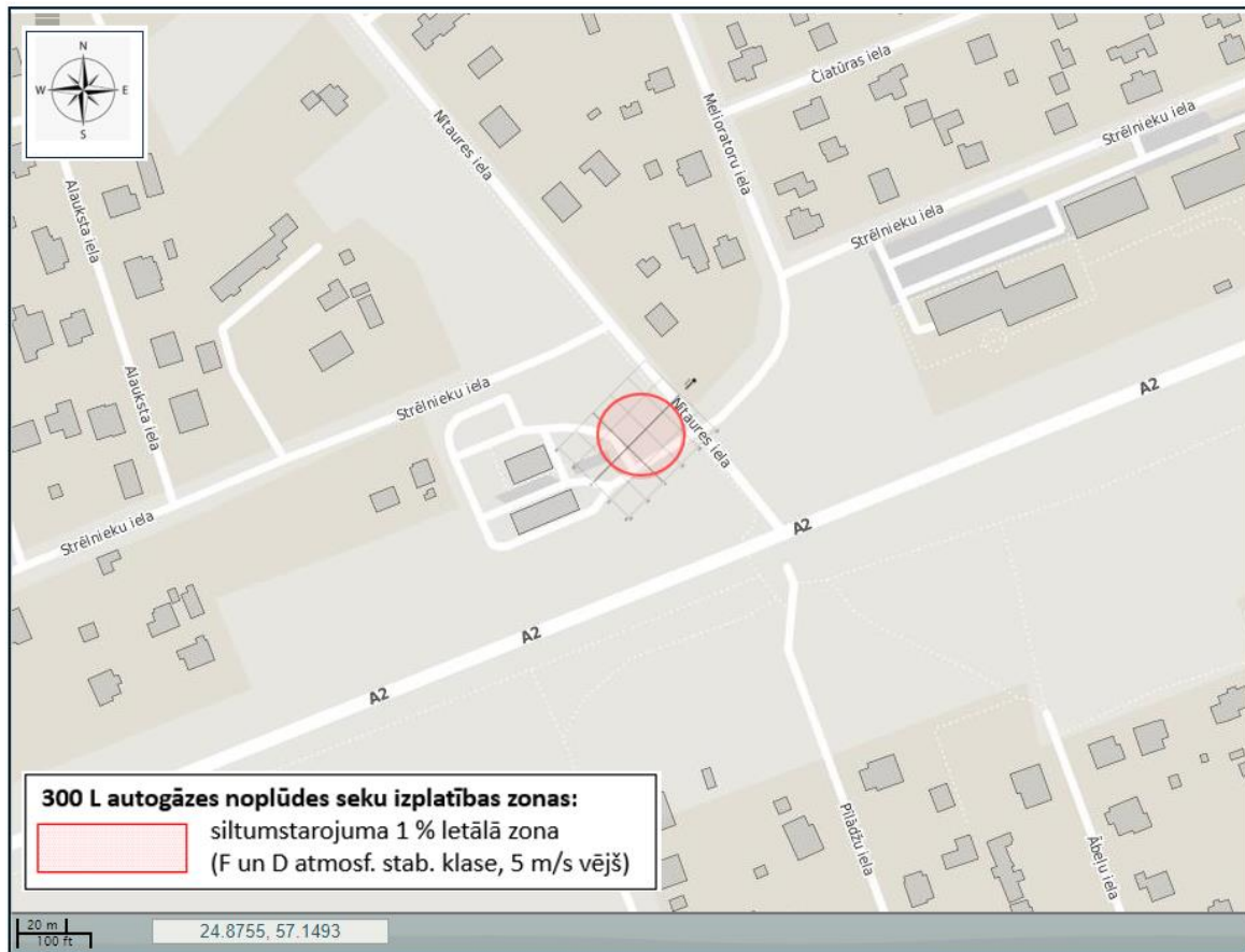
4.7. att. Siltumstarojuma izplatības zona 300 L noplūdušas autogāzes gadījumā (ar degšanu)
