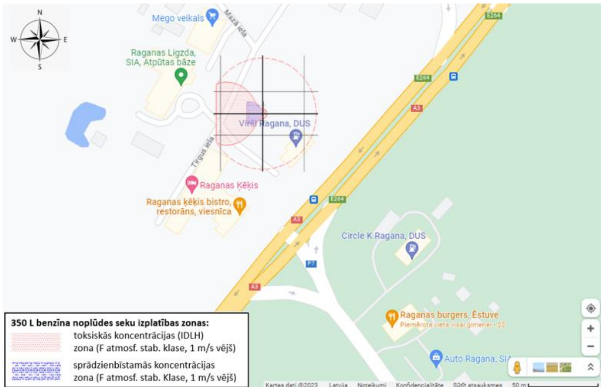
4.2. att. Toksiskās un sprādzienbīstamās koncentrācijas izplatības zonas 350 L noplūduša benzīna gadījumā (bez degšanas)
