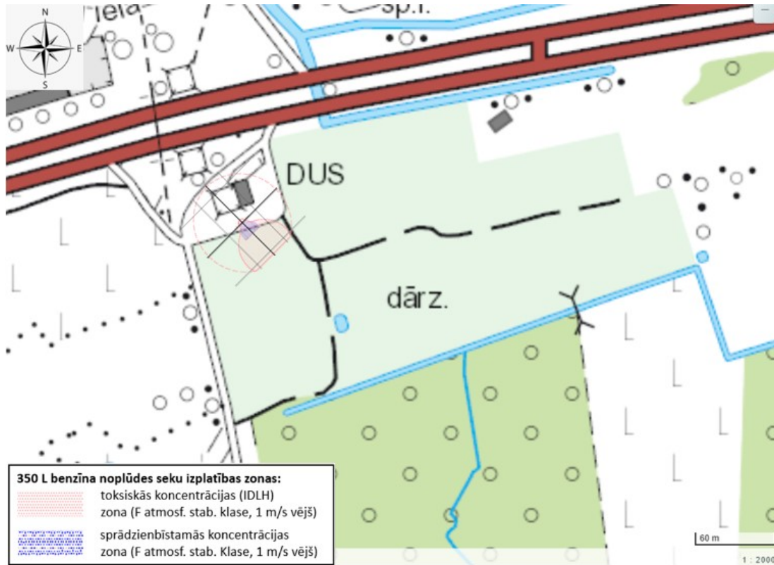
4.2. att. Toksiskās un sprādzienbīstamās koncentrācijas izplatības zonas 350 L noplūduša benzīna gadījumā (bez degšanas)
