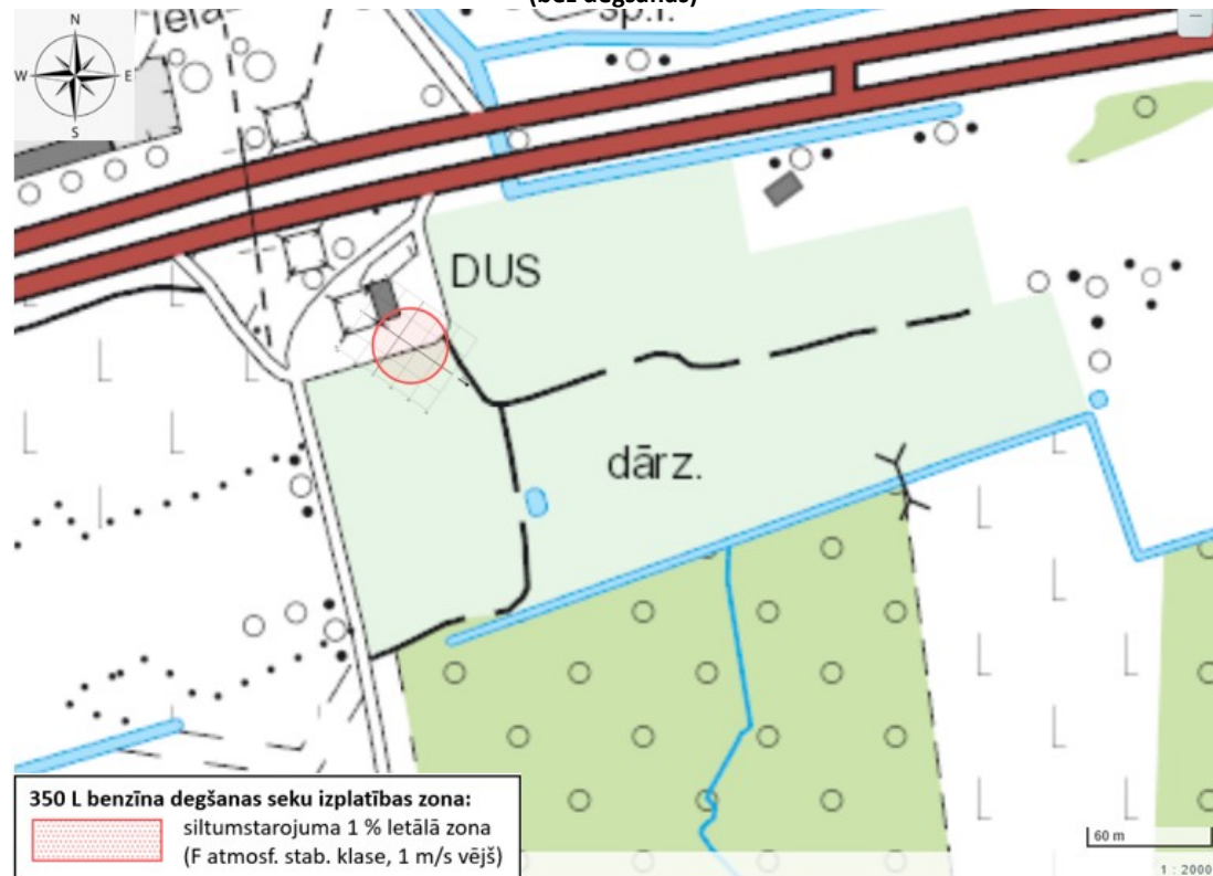
4.3. att. Siltumstarojuma izplatības zona 350 L noplūduša benzīna gadījumā (ar degšanu)
