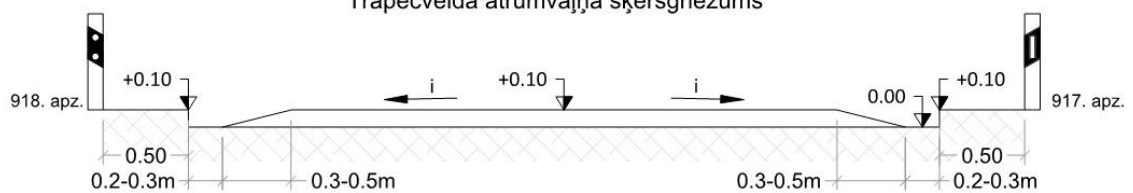
Trapecveida ātrumvalņa šķērsriezums
