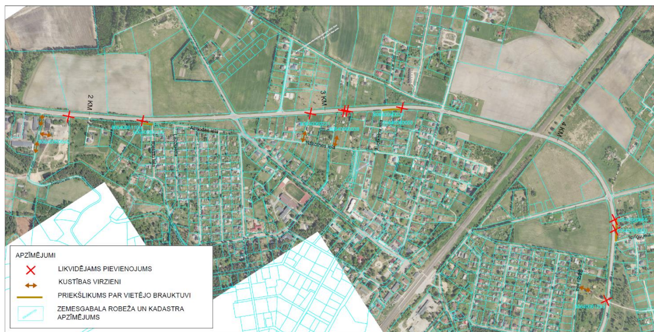
15. attēls. Pievienojumu pārkārtošanas shēma pie P10 posmā no 1.92 – 4.77 km
